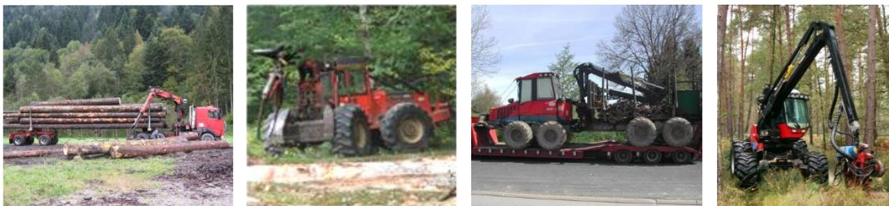
Ci-dessus, de gauche à droite : grumier, skidder, porteur sur porte-engins, abatteuse.
